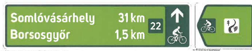
Figura 215: Exemplu de indicator de orientare și de confirmare a traseului (Ungaria)
