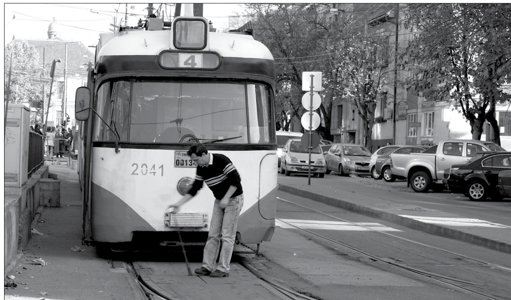
Vatmanii din Timișoara se dau jos în fiecare intersecție ca să schimbe macazul cu ranga
