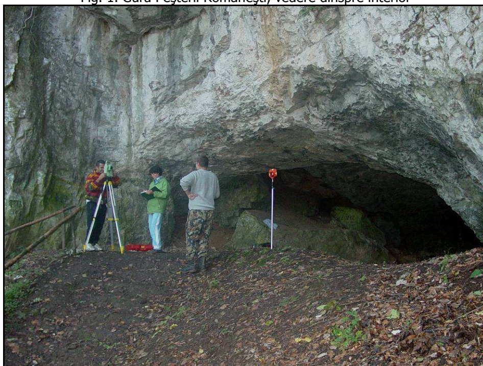
Fig. 2. Topografierea cu Stația Totală a zonei de intrare în peșteră
